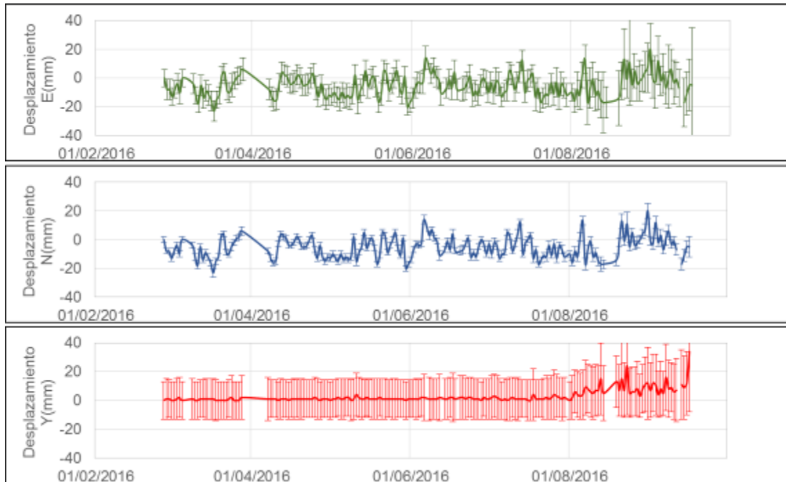
Figura 69. Variaciones en las direcciones Norte, Este y altura de la estación GNSS La Palma instalada sobre la superficie del volcán Doña Juana, para el periodo comprendido entre el 27 de febrero de 2016 y el 29 de Septiembre de 2016.
